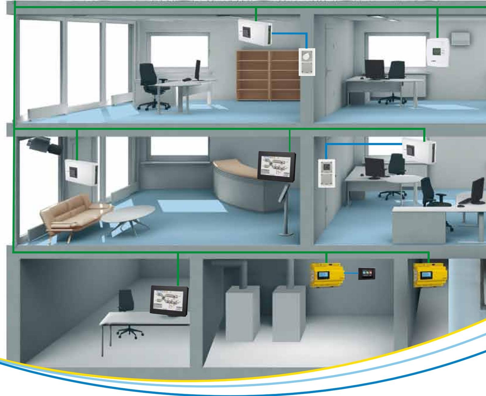
La soluzione **flex<sup>BAC</sup>vision** comprende una gamma di prodotti e soluzioni per l'automazione, la gestione e la supervisione degli impianti di riscaldamento e climatizzazione a servizio di medi e piccoli edifici.
