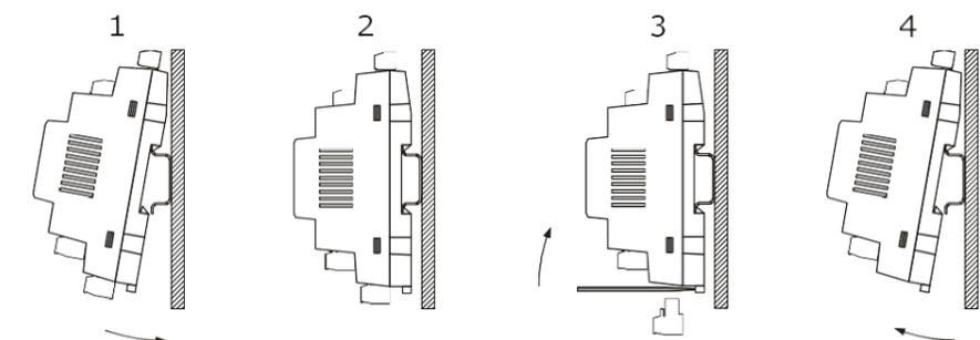
Per rimuovere i dispositivi rimuovere prima eventuali morsettiere estraibili a vite inserite nella parte bassa, quindi operare sulla clip per la guida DIN con un cacciavite nel modo indicato nel seguente disegno.
